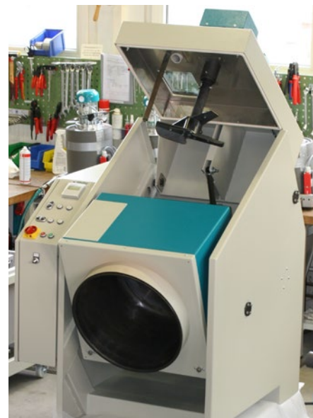
Лабораторный лопастной смеситель Infratest (на фото — в положении выгрузки)
