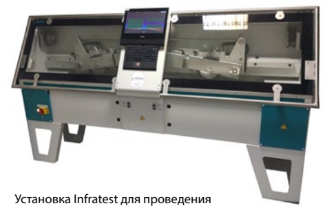
Установка Infratest для проведения испытаний на колееобразование
