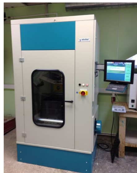
Катковый секторный уплотнитель Infratest
