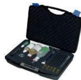
Мини-лаборатория для анализа Ph и Gh растворителя
